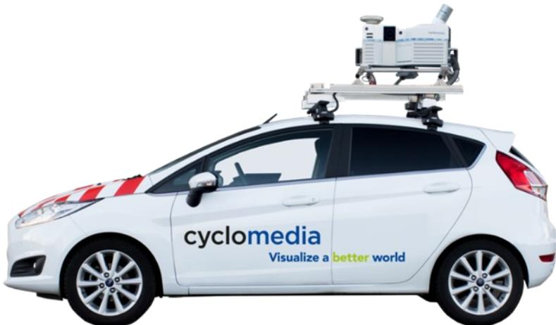
**Abbildung 2: Aufnahmefahrzeug von Cyclomedia inklusive des patentierten Erfassungssystems**
