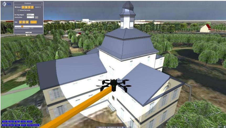
**Abbildung 2: Simulation des Drohnenfluges einschließlich Ausrichtung/Neigung der Kamera**
