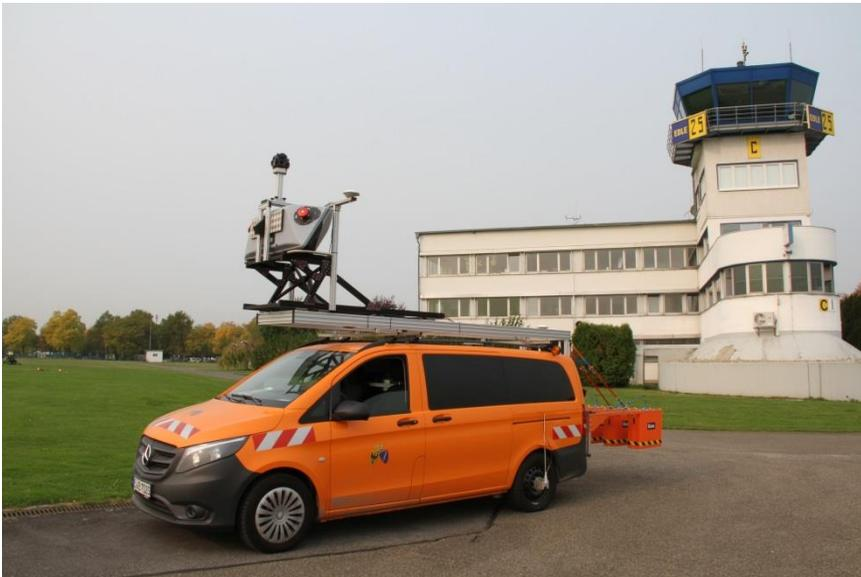
Abbildung 1: Mobiles-Multi-Sensor-Messfahrzeug der Stadt Essen
