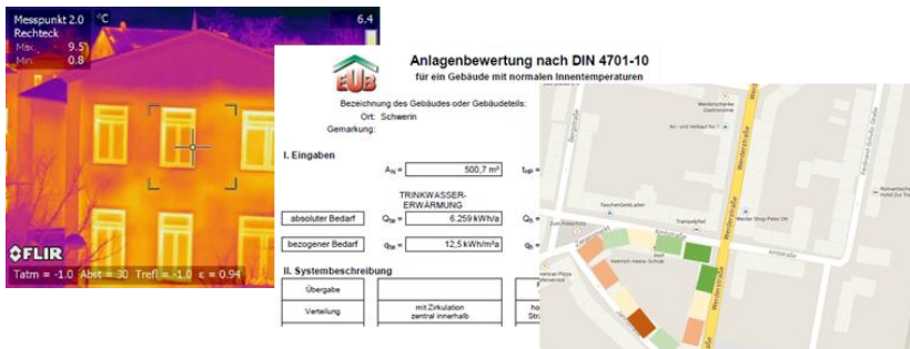
Abbildung 4: Thermografische Auswertung der Gebäudehülle, Berechnung von Energiekennwerten, GIS-Kartendarstellung des gebäudebezogenen Energiebedarfs eines Straßenzugs (Quelle: Google Maps (rechts)).
