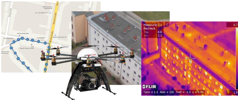
Abbildung 3: Datenerhebung – Befliegungsplan für Kameradrohne, Fotos und thermografische Aufnahmen der Gebäudehülle (Quelle: Google Maps (links), Volocam Rostock (Drohne)).
